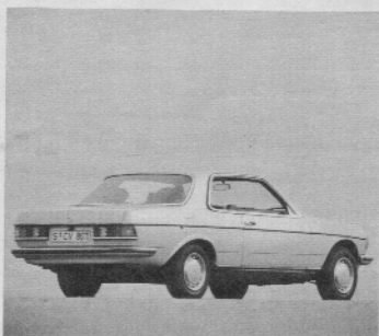
... pfostenlose, voll versenkbare Seitenfenster
