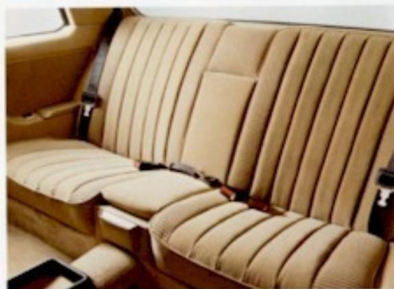
Längsrichtung, Lehnenneigung und der Höhe individuell einstellbar. Die Lehnen-Arretierung erfolgt durch Unterdruck und wird automatisch beim Öffnen der Türen oder durch Knopfdruck gelöst.
